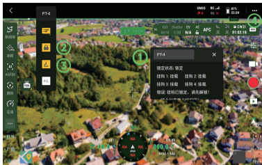
① Pilot2 PT-4负载信息悬浮窗 ② 解锁/锁定 ③ 投放 ④ 菜单功能
